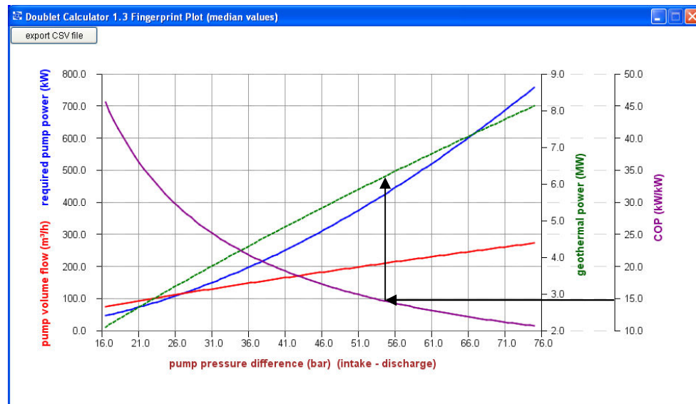
Figuur C2. Voorbeeld van vermogensgrafiek uit DoubletCalc. Op basis van aquiferparameters berekend Doubletcalc het pompvermogen, het debiet (pomp volume flow), benodigd geothermisch vermogen en het rendement (COP) bij toenemende pompdrukverschil. Het gaat hierbij om het verschil in pompdruk tussen de injectie en productieput. Het rendement (COP) daalt zodra meer pompvermogen gebruikt moet worden om een gewenst debiet en daaraan gerelateerd geothermisch vermogen te berekenen.
