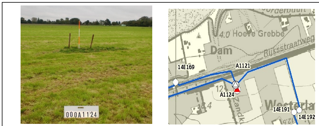
Figuur 1 NAP-peilmerk OA1124 (ondergronds peilmerk) gesitueerd oostelijke rand van het meetnet
