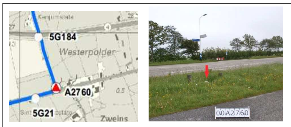
Figuur 1 Aansluitpunt NAP-peilmerk 00A2760 (ondergronds peilmerk)
