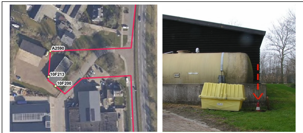
Figuur 2: NAP-peilmerk 000A2590 (aansluitpunt).
