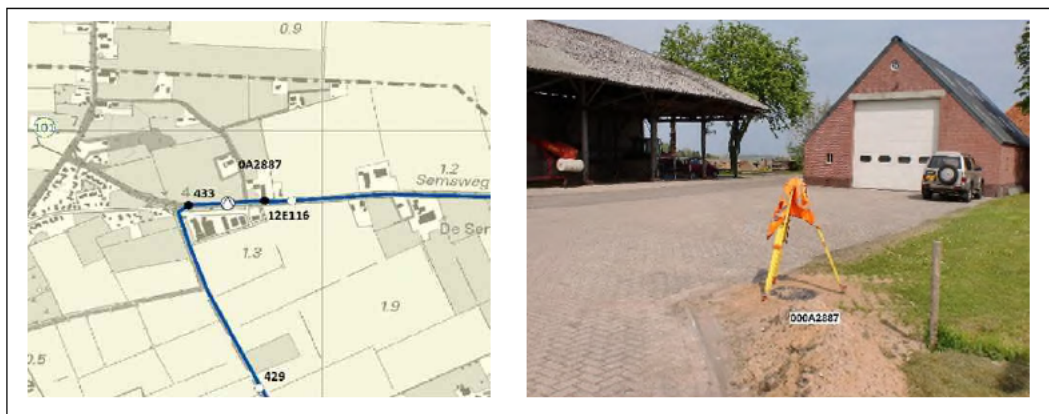
Figuur 1 NAP-peilmerk 000A2887 (ondergronds peilmerk) gesitueerd westelijke rand van het meetnet
