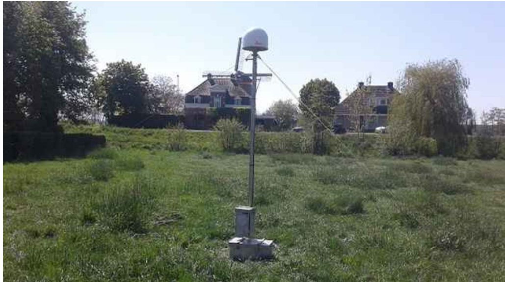
Meetopstelling locatie Arkel (GPS-meting 2020)
