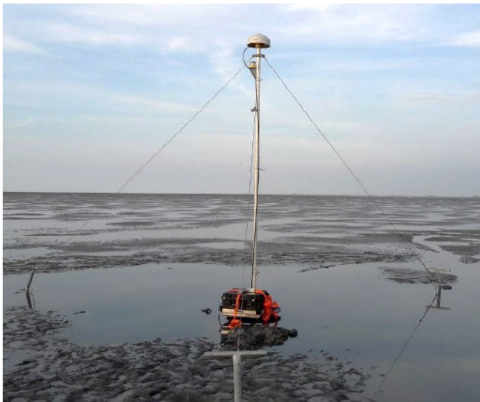
Figuur 7: Meetopstelling jaarlijkse GNSS monitoring
