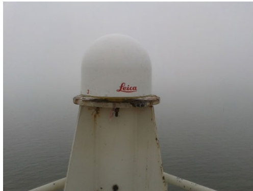
Figuur 4 Meetlocatie Zuidwal met een Leica AR25 choke-ring antenne (meting oktober 2011)
