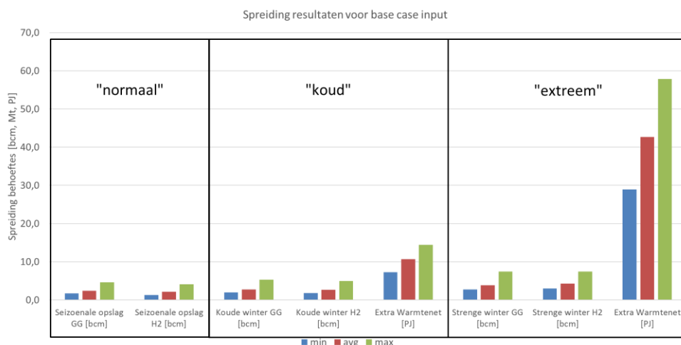
Figuur 4-22: Spreiding van de warmte behoefte tussen de verschillende scenario's voor een normale, koude en extreme winter: het minimum wordt met blauw, het gemiddelde met rood en het maximum met groen aangegeven.
