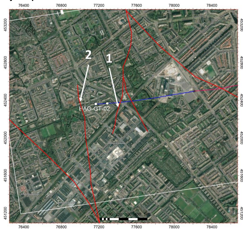
Figuur 13: Positie en nummering van de twee breuken ten opzichte van de top en basis van het reservoir in de injectieput en waarvan de modelresultaten in de onderstaande figuren zijn weergegeven.
