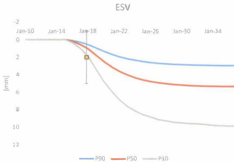
Figuur 4-7 Meting en voorspelling conform winningsplan (ref. 23). De meting komt te vroeg om tot een significante herkolibratie te leiden.
