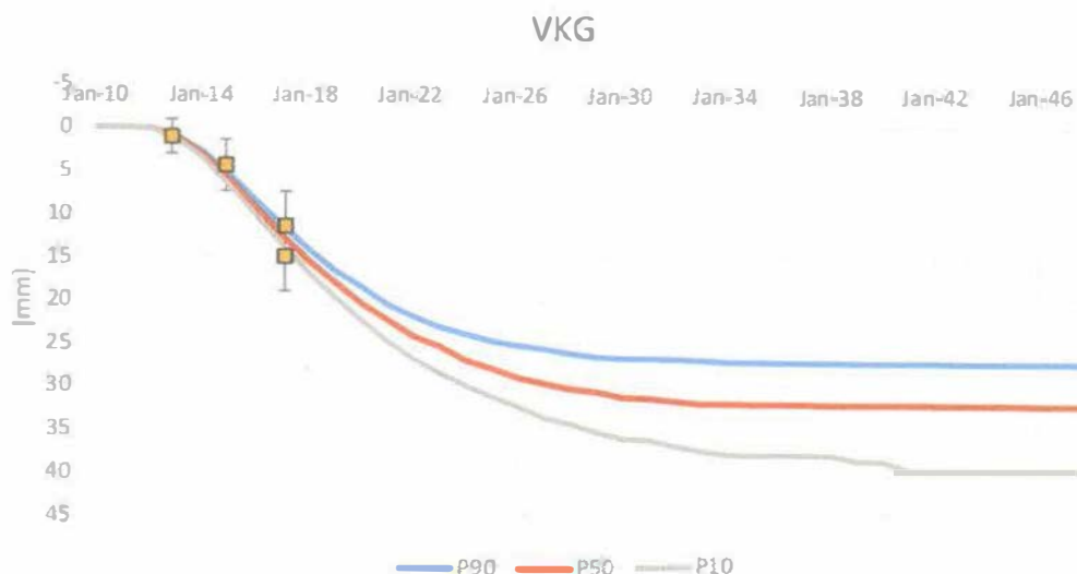
Figuur 4-3 Herkolibratie van de Vinkega dalingskrommen aan de metingen (GPS en waterpassing).
