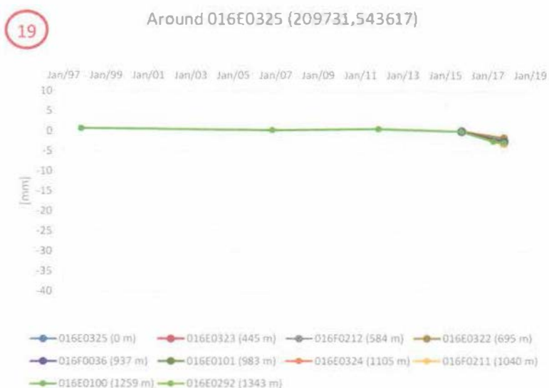
Figuur 7-8 Daling ten NW van het Diever voorkomen. Hier heeft het model de grootste daling als we aannemen dat Diever een groter depletiegebied heeft. Als we deze figuur vergelijken met Figuur 3-17 en Figuur 7-7 zien we dat door nog geen indicatie voor is; op alle drie de punten is de daling niet of nauwelijks significant. Het rode cijfer geeft de locatie aan op Figuur 3-3.
