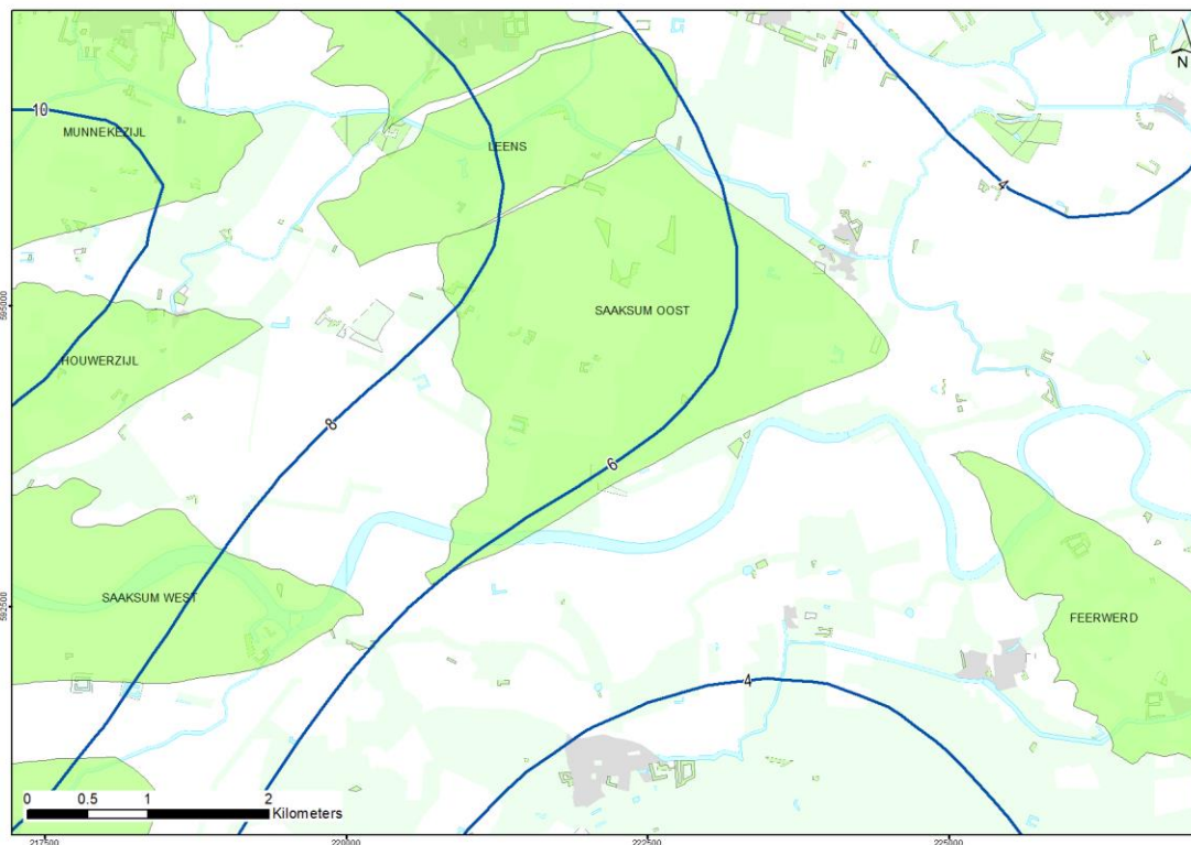
Figuur 7-5: Prognose voor 2035 van de totale bodemdaling door gaswinning voor het Saaksum-Oost voorkomen in combinatie met naburige voorkomens. De contourlijnen geven de voorspelde bodemdaling in cm aan.
