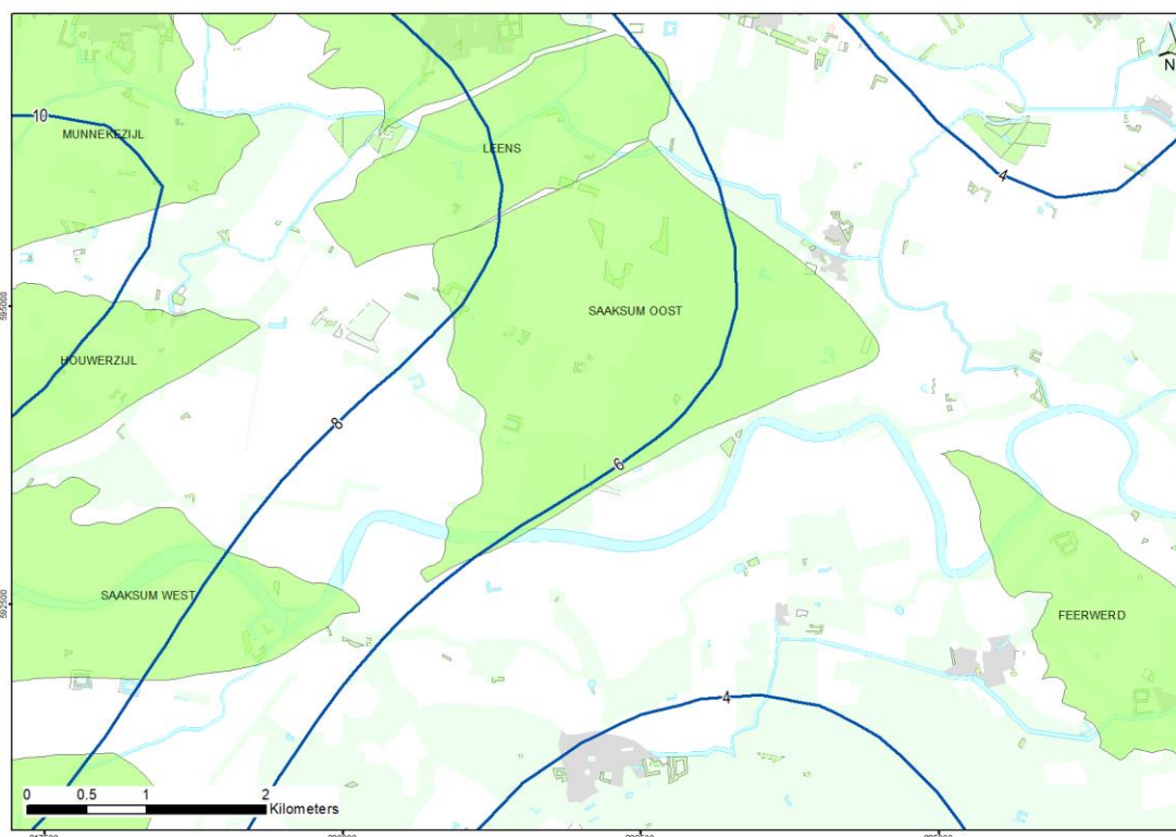
Figuur 7-6: Prognose voor 2050 van de totale bodemdaling door gaswinning voor het Saaksum-Oost voorkomen in combinatie met naburige voorkomens 19 jaar na beëindiging van de winning in Saaksum-Oost. De contourlijnen geven de voorspelde bodemdaling in cm aan.
