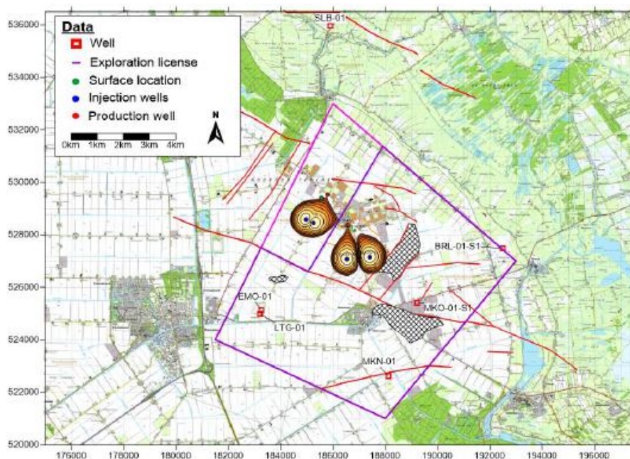
Figuur 15: Gebiedsbegrenzing Opsporingsvergunning en winningsvergunning Hoogweg Aardwarmte BV met thermische contouren injectieputten
