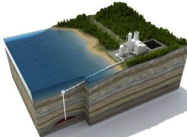
Schematische 3D weergave van opslag in olie/gasveld (bron: www.practicapro.co.uk )
