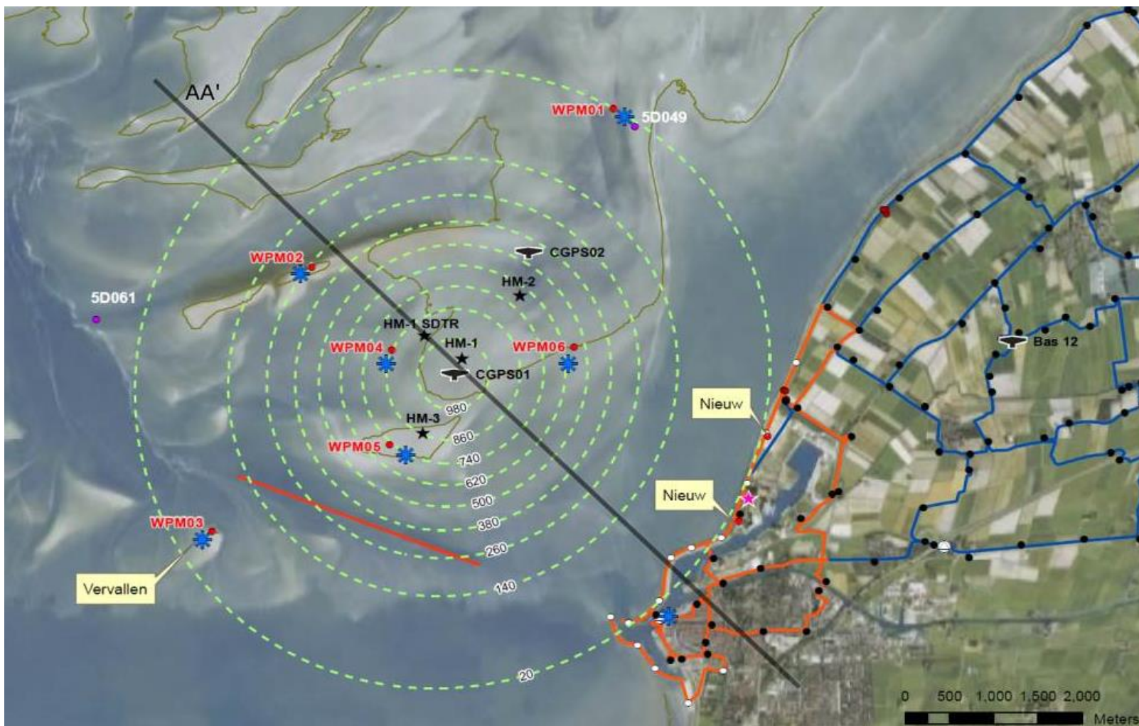
FIGUUR 2: GEKOZEN DOORSNEDE DOOR DE VOORSPELDE BODEMDALINGSSCHOTEL
