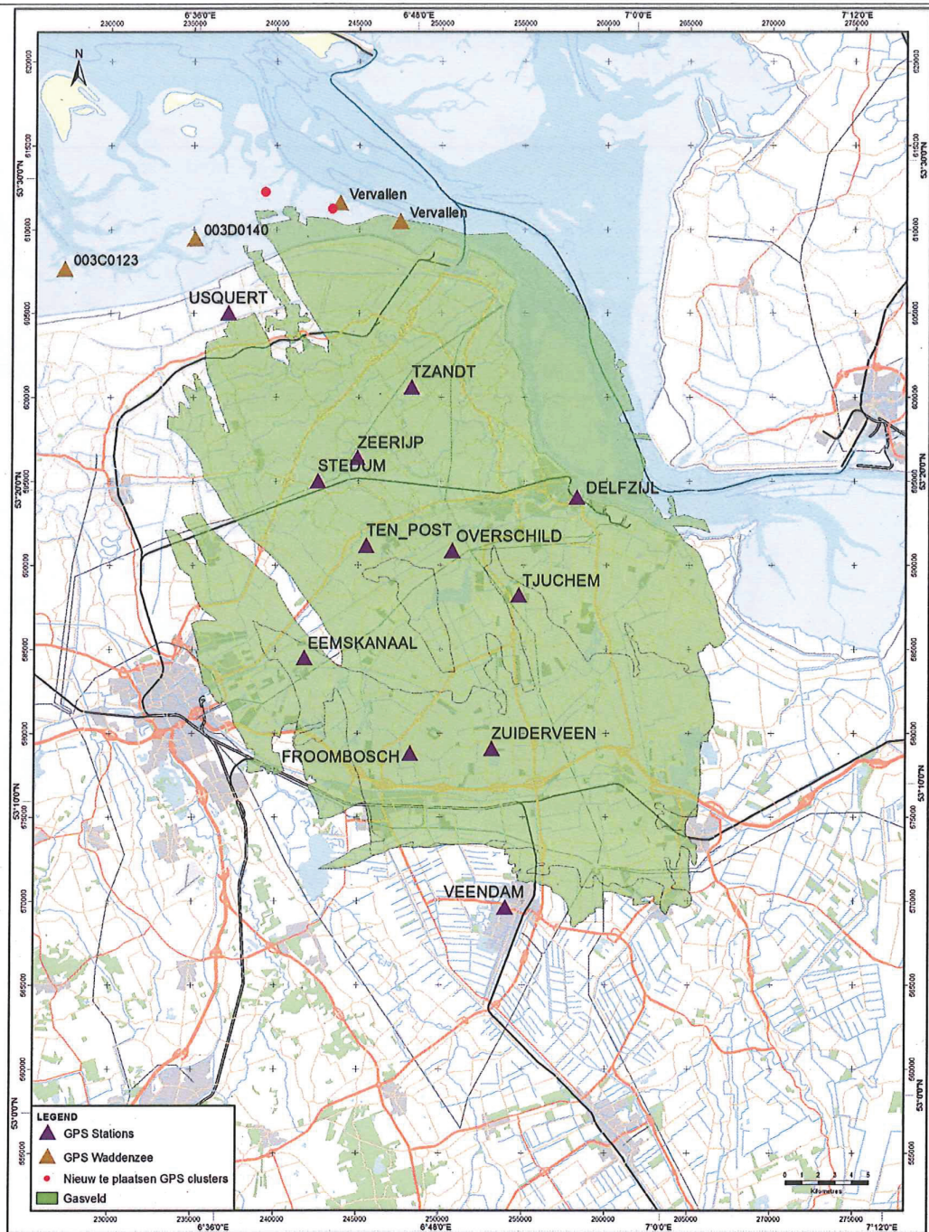
Figuur 2: GPS meetstations: paarse driehoeken: permanent registrerende GPS stations. Bruine driehoeken: peilmerkclusters, welke middels campagne GPS regelmatig worden gemeten. Rode punten: nieuw te plaatsen GPS clusters (Waddenzee)
