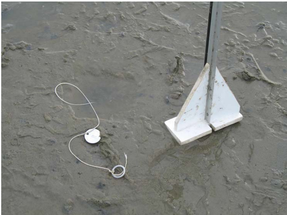
Foto 2 Geplaatste spijkerpunt, draad, meetring en label (windrichting), meetliniaal waar hoogte van Wad tot ring gemeten wordt
