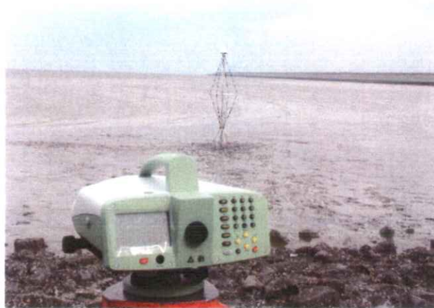
Figuur 6.1 Test opstelling Lauwersoog (afgekeurde GPS meetpaal)
